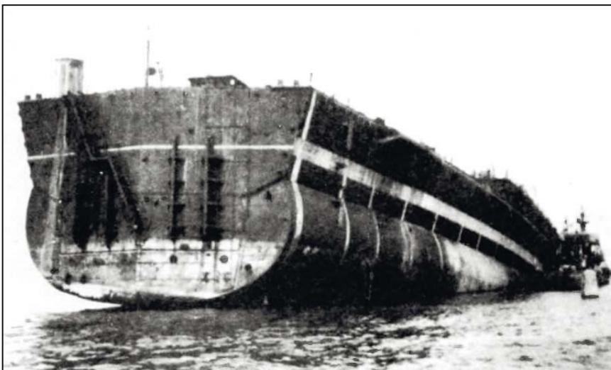
Отсек недостроенного корпуса ТКР пр. 82, использованный в качестве мишени. Потопить ракетами его так и не удалось!
