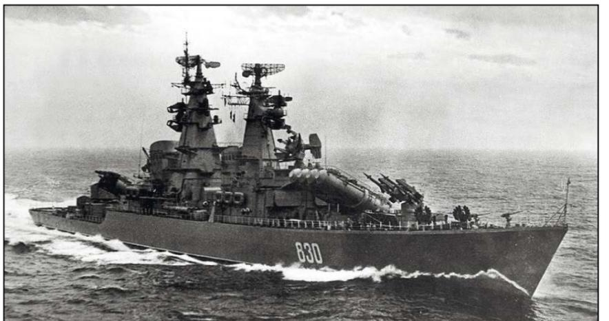
**Ракетный крейсер "Грозный", 1962 год. Первый в мире корабль, оснащенный двумя ракетными комплексами — противокорабельным П-35 и зенитным М-1 "Волна". Для американских адмиралов стало неприятным сюрпризом, что крейсер-эсминец водоизмещением 5500 тонн способен обстреливать АУГи с дистанции 350 км.**
